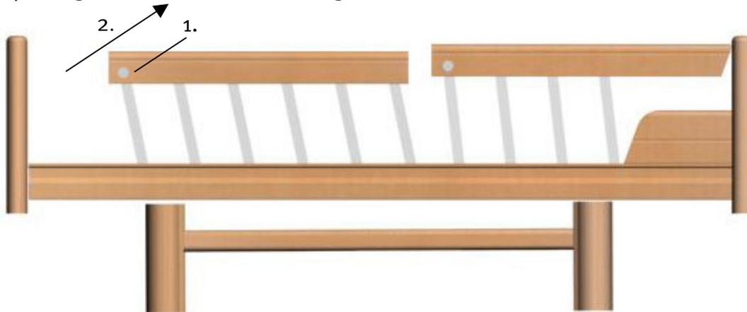
Um die Seitensicherungen herabzulassen, drücken Sie den Knopf am unteren Ende des jeweiligen Elements der Seitensicherung und bewegen die Seitensicherung nach unten. Beginnen Sie mit dem fußseitigen Teil der Seitensicherung.
