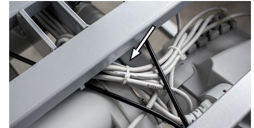
Position des Kabelbinders über dem fußseitigen Liegeflächenmotor.
